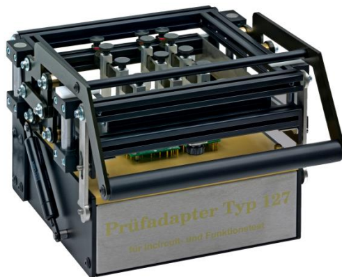
Obr. 3.4. – Bed of nails testovací přípravek. [16]
