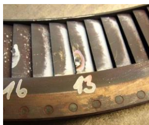
Obrázek 26 Trhlina lopatky č. 13 na prvním nosiči lopatek ve 4. rozváděcí radě [1]
