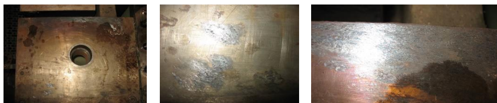
Obrázek 25 Stopy po působení výbojů elektrostatické elektřiny na ploše spodní poloviny ložiskového stojanu [1]
