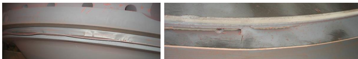
Obrázek 28 Pokřivený těsnící břit a trhlina na parní ucpávce [1]
