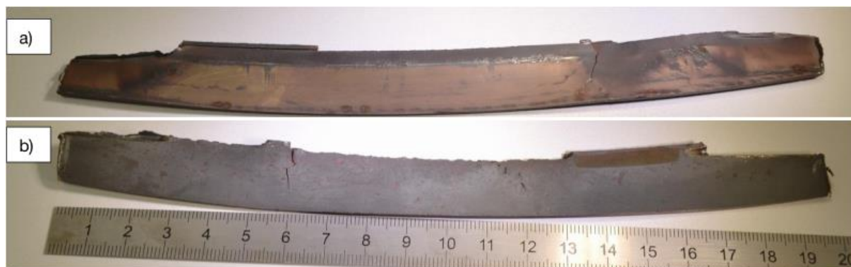
Obrázek 42 Održena část plechového prstence pro analýzu. a) strana opření prstence; b) strana přivrácená do komory s vyšším tlakem [1]
