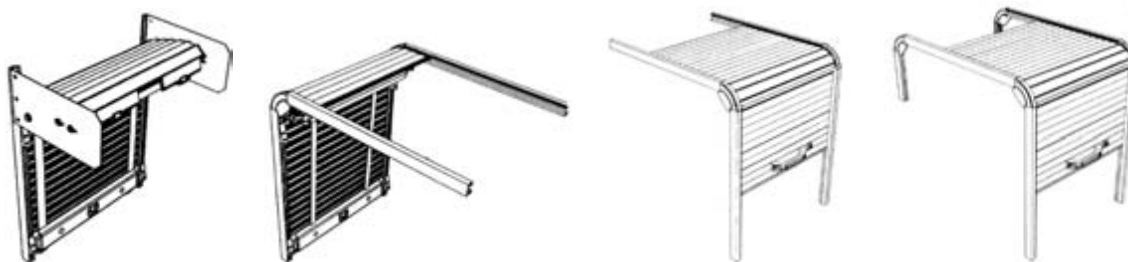
Obr. 12 typy rolet [17]: a) navíjení na buben, b) navíjení pod střechem, c) zasouvání pod střechem, d) zasouvání pod střechem a dozadu.
