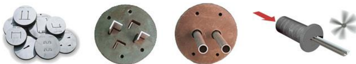
Obr. 6 Lisovací matrice [7,14,24]: a) různé tvary, b) L profil, c) trubky, d) protlačení Ingotu.
