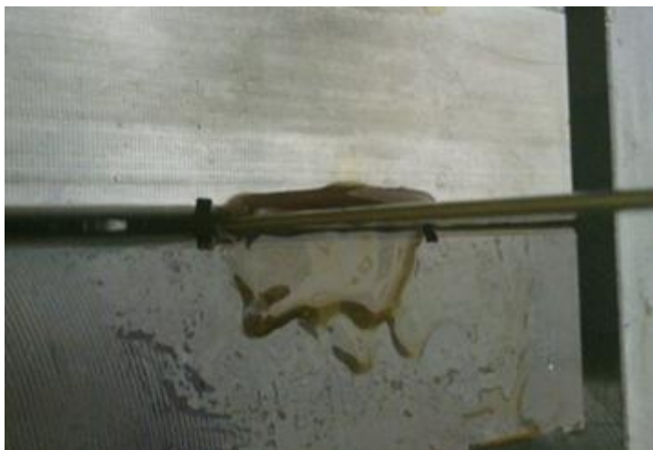
Obr. 42 Stírání maziva hranou přípravku
