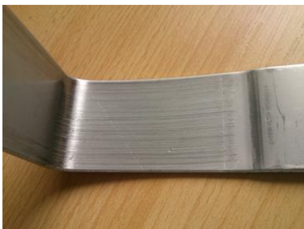
Obr. 52 Poškození tažnou hranou
