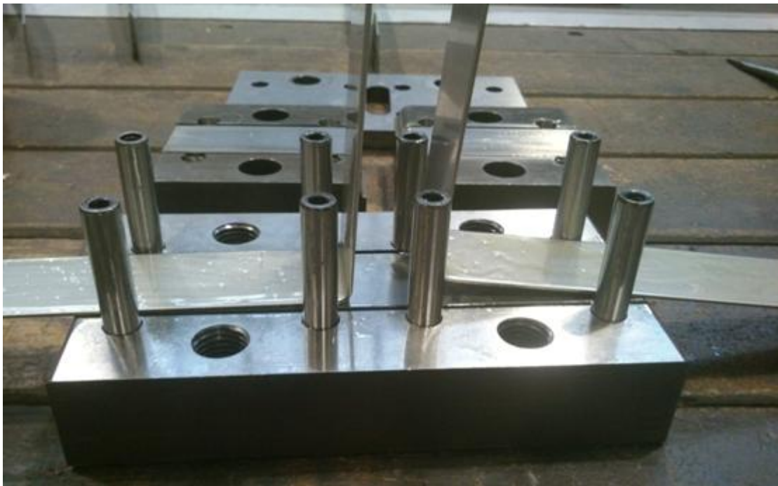
Obr. 41 Umístění pásků plechu do přípravku s nanesenou vrstvou maziva
