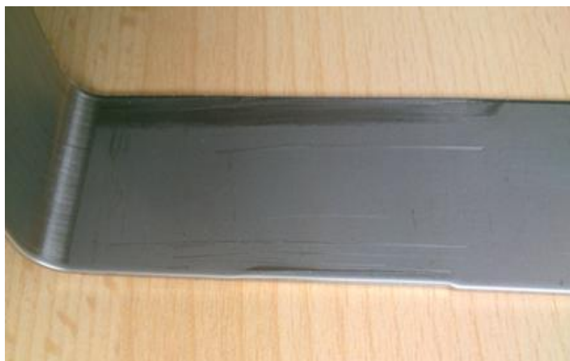
Obr. 56 Poškození způsobené vybočením
