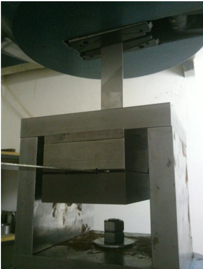
Obr. 37 Upnutí sestaveného přípravku ve stroji
