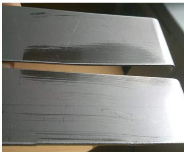
Obr. 51 Poškození od přidržovače
