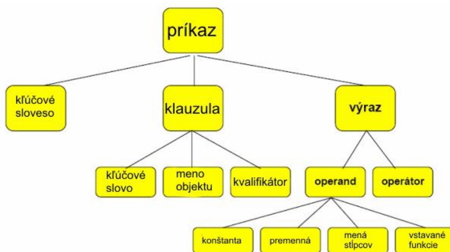
Obr.1 Štruktúra SQL príkazu [3]
