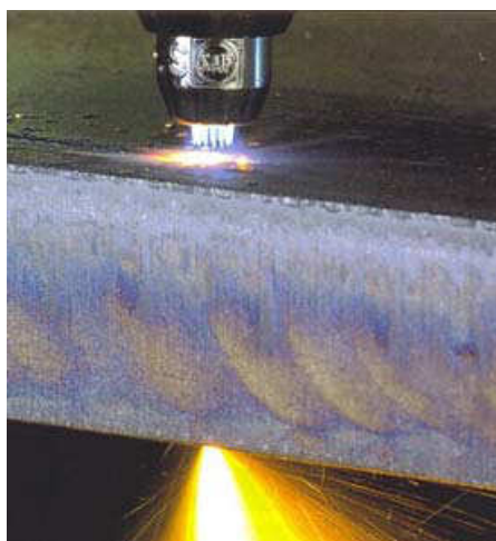
Obr. 25 Kyslíkové řezání vysokovýkonnou tryskou [12]
