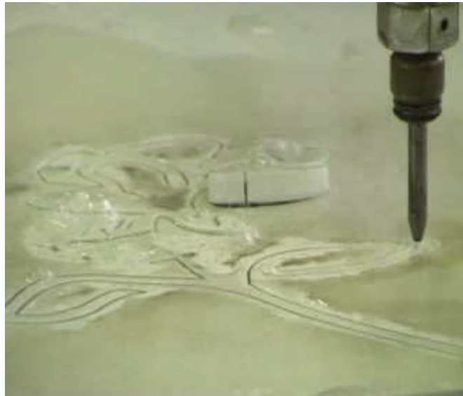
Obr. 31 Detail vysokotlaké trysky řezající plast [16]
