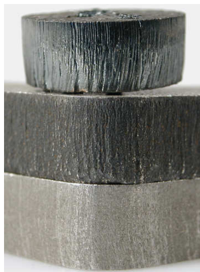
Obr. 34 Porovnání řezů v oceli: shora laser (tl. 7 mm), plazma (tl. 8 mm), AWJ (tl. 8 mm) [13]
