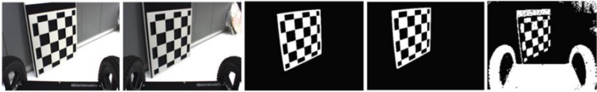
Obr. 76 Snímky druhé kalibrační desky: vlevo - CCD kamery (2 snímky), vprostřed - termokamery (2 snímky), vpravo - dálkoměrná kamera
