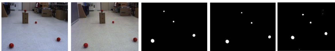
Obr. 89 Snímky prvního navrženého terče pro ověření přesnosti datové fúze: z levé a pravé CCD kamery (vlevo), z levé a pravé termovizní kamery (uprostřed) a snímek intenzity z dálkoměrné kamery (vpravo)
