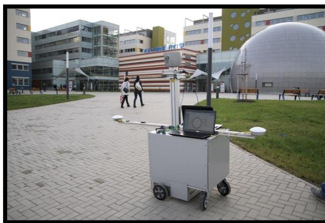
Obr. 53 Mapovací robot EnvMap se skenerem Velodyne HDL-32
