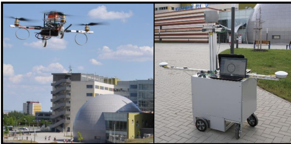
Obr. 29 Létající robot Uranus-ALU(vlevo), mapovací robot envMap (vpravo)
