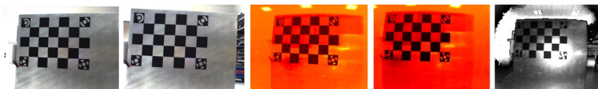
Obr. 74 Snímky první kalibrační desky: vlevo - CCD kamery (2 snímky), vprostřed – termokamery (2 snímky), vpravo - dálkoměrná kamera.
