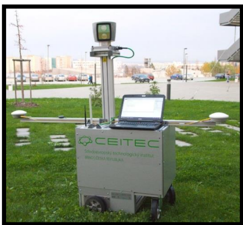
Obr. 52 Mapovací robot EnvMap se skenerem Velodyne HDL-64
