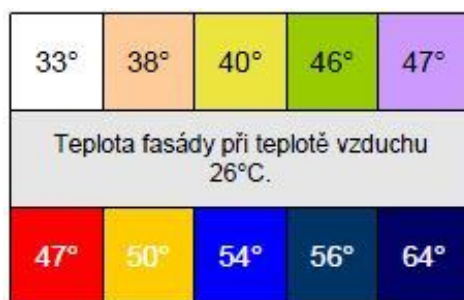
Obr. 11.4-4: Přibližné hodnoty povrchové teploty fasády při venkovní teplotě 26°C
