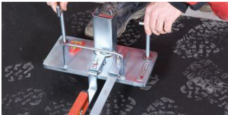
Obr. 4-6: Měnitelné nastavení vyrovnávací soupravy
