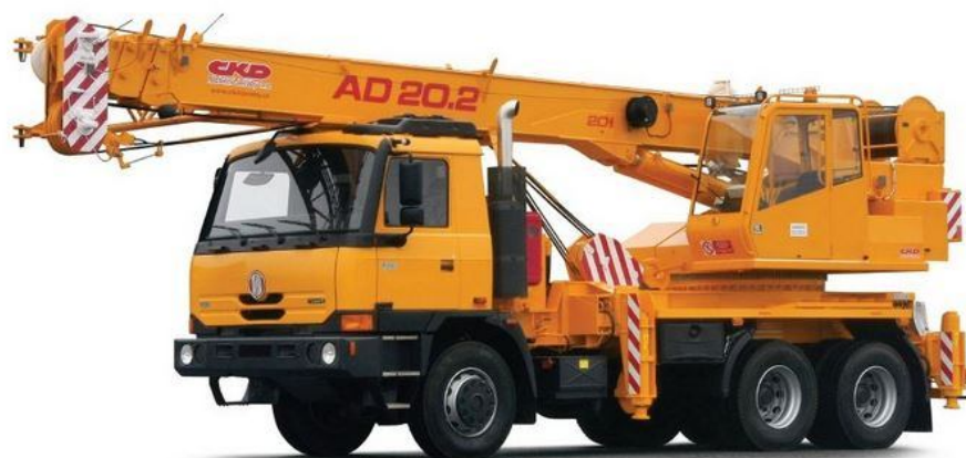
Obr. 8-1: Autojeřáb Tatra AD 20
