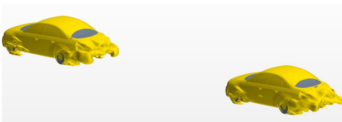
Príloha 9 Úplav zobrazený izoplochou atmosférického tlaku vozidiel vzdialených 8 m
