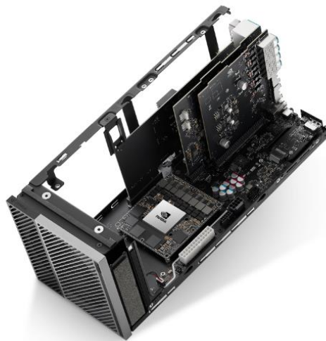
Obrázek 23: Elektronická řídicí jednotka DRIVE AGX Orin DevKit [53]
