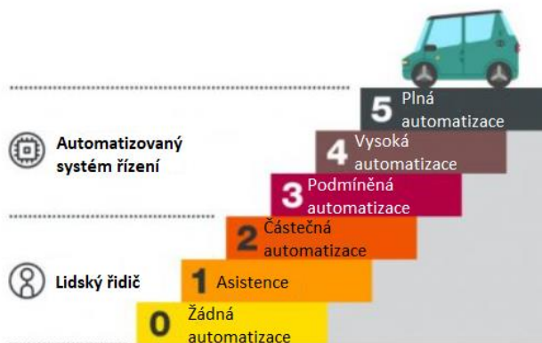
Obrázek 13: Úrovně automatizace podle SAE [33]
