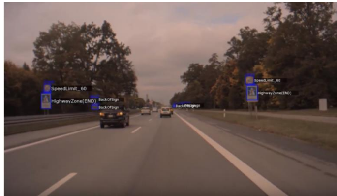
Obrázek 24: Klasifikace dopravního značení pomocí SighnNet DNN [48]
