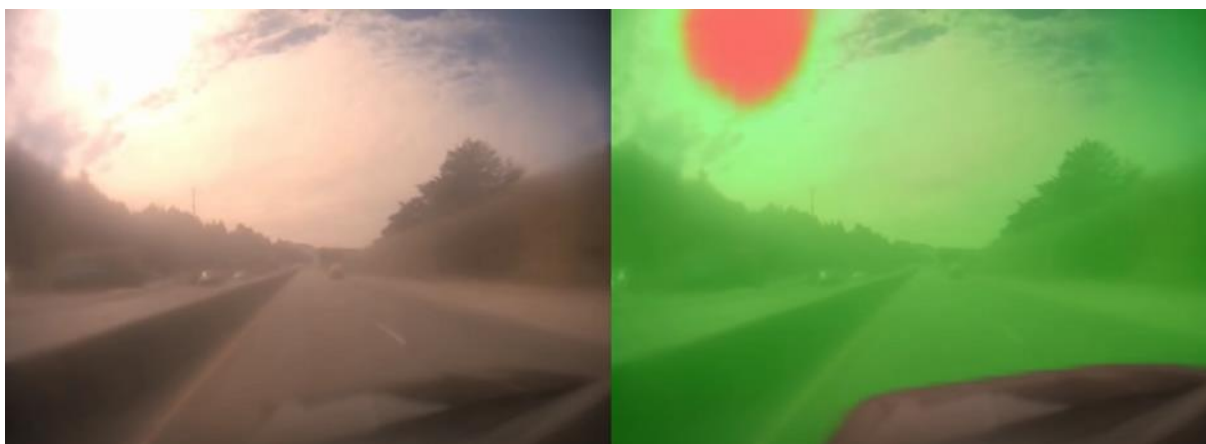
Obrázek 28: Vidění autonomního vozidla pomocí ClearSightNet DNN [52]
