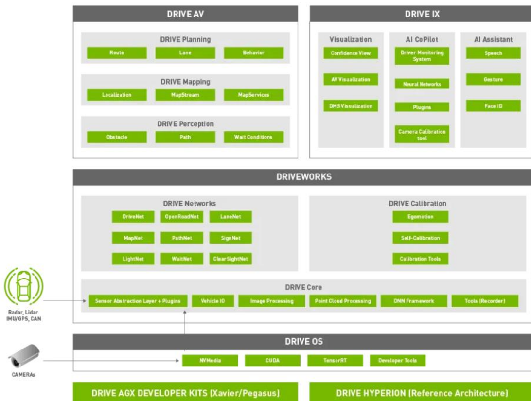
Obrázek 22: Architektura fungování autonomního vozidla od společnosti NVIDIA [51]
