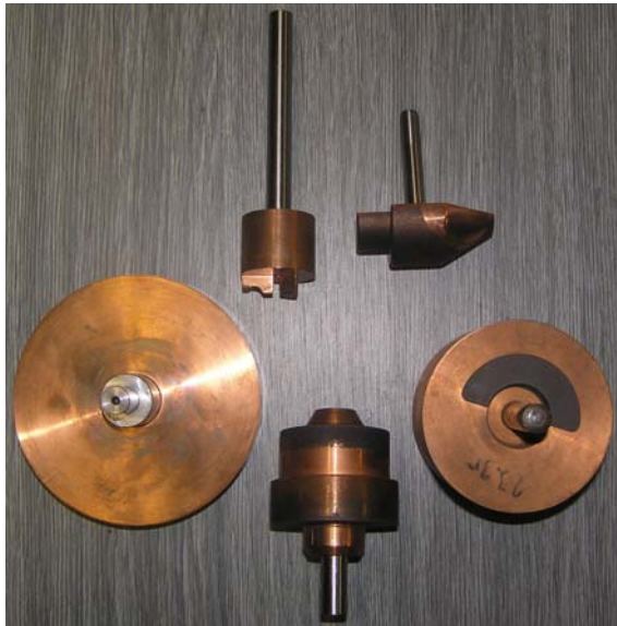
Obr. 1-22 různé tvary nástrojových elektrod pro hloubení
