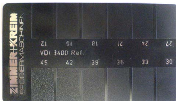
Obr.1-18 destička drsnosti pro vizuální porovnání od firmy Zimmer+Kreim
