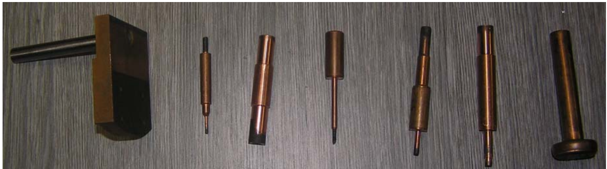
Obr. 1-21 detail nástrojové elektrody pro hloubení
