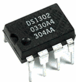
Obr. 1.8: Integrovaný obvod reálného času DS1302 (převzato z [4])
