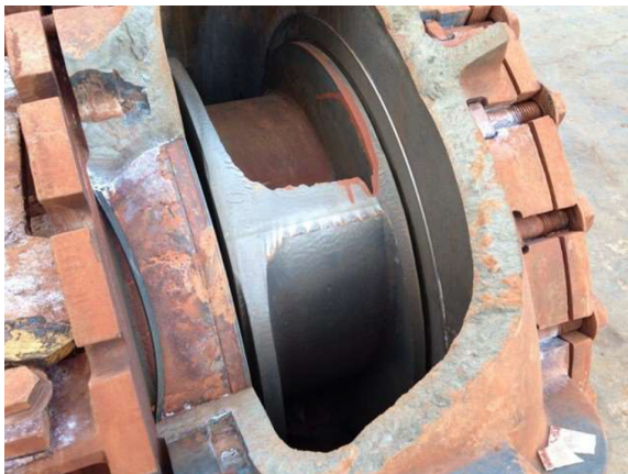
Obrázek 5.8: Poškození čerpadla v důsledku vodního rázu [2]
