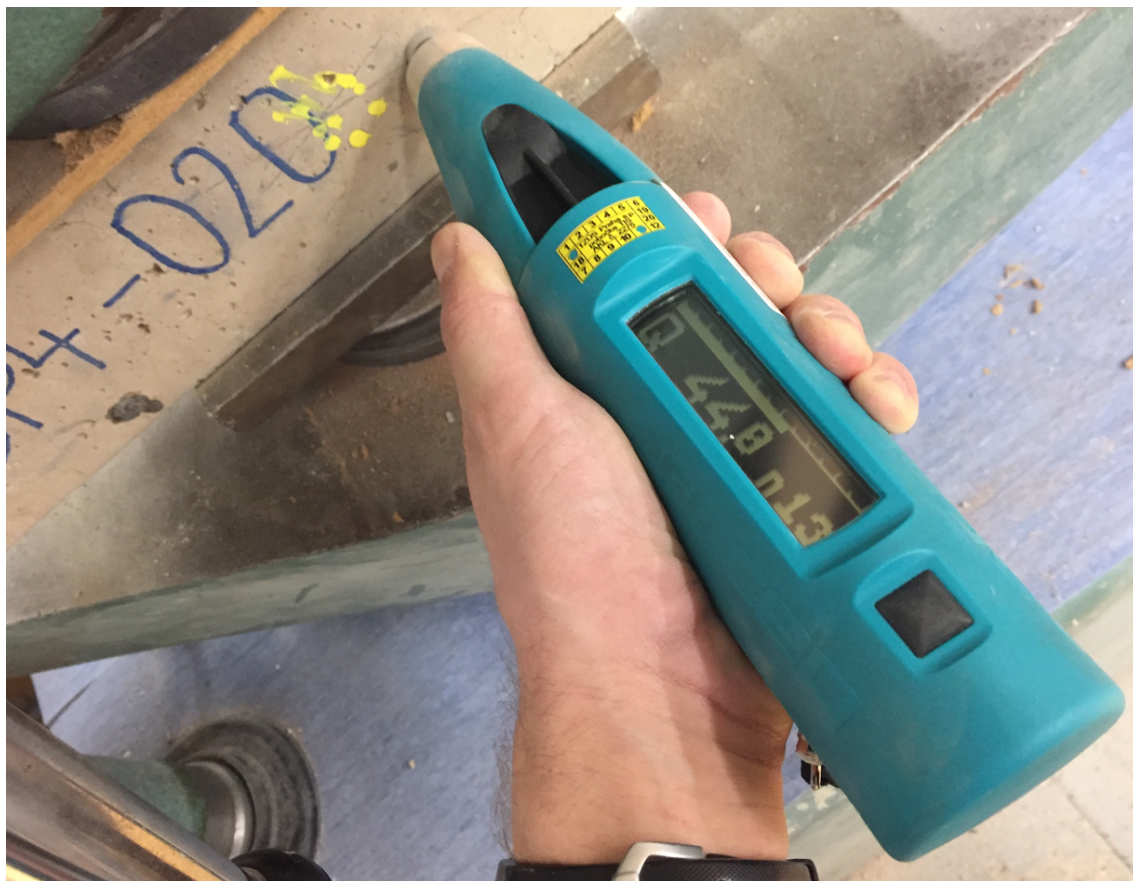
Obrázek 5.13: Zkoušení tvrdosti Schmidtovým tvrdoměrem na trámčích.
