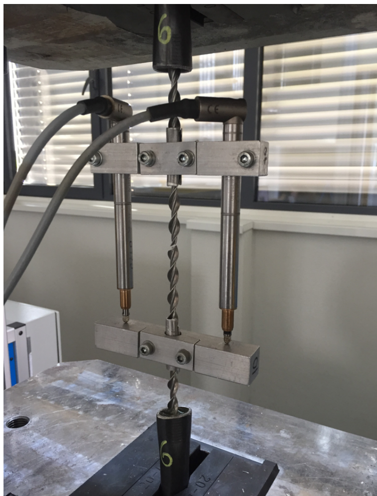
Obrázek 5.3: Ukázka tradičního způsobu zkoušení výztuže, aplikovaného na helikální výztuž.
