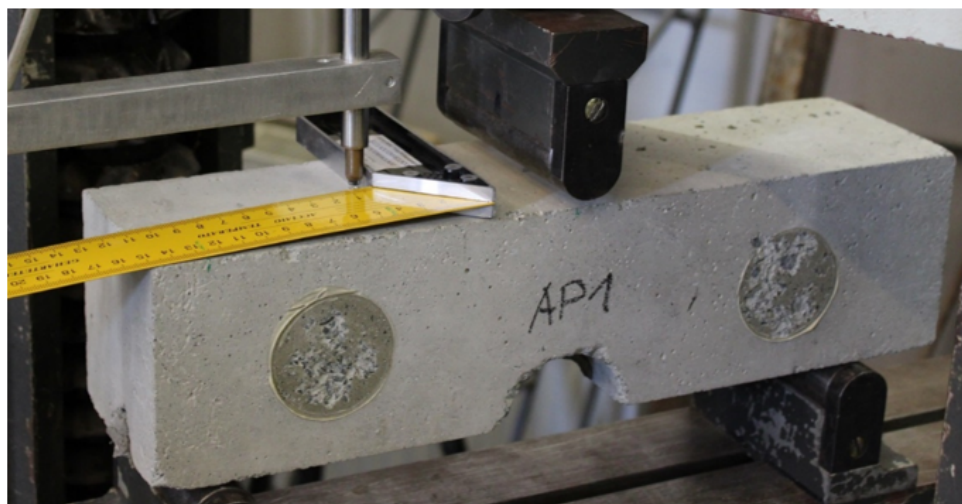
Obrázek 5.18: Schéma sestavené trámčové zkoušky, ukazující použité proměnné (nahore) a její fotografie (dole). Připraveno k publikaci v [47].
