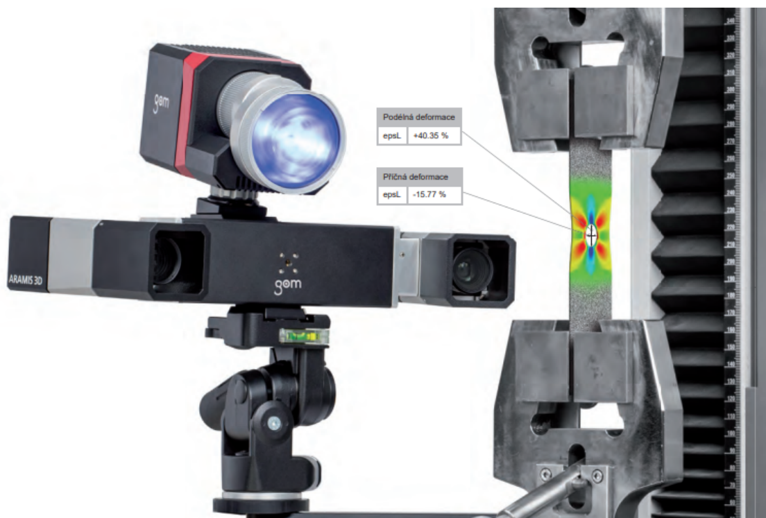
Obrázek 3.15: Ukázka měření pomocí systému ARAMIS, založeného na principu digitální korelace obrazů („Digital Image Correlation“ – DIC). Převzato z [39].
