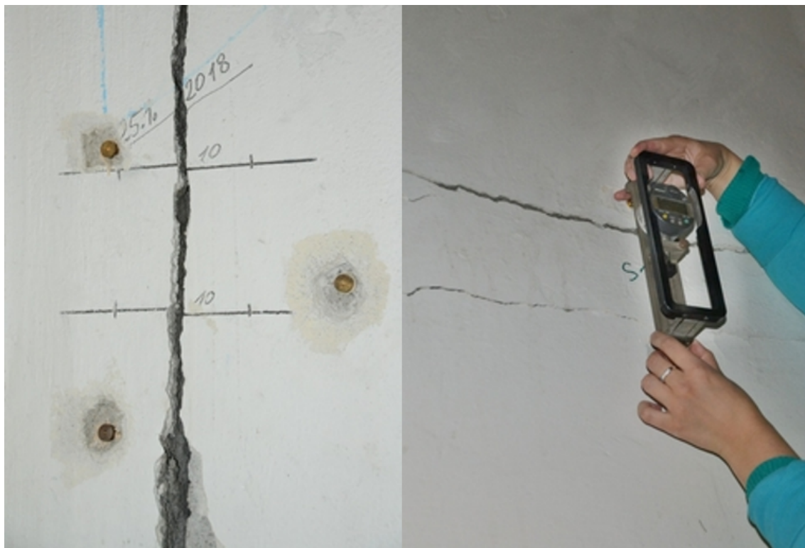
Obrázek 3.3: Měření deformací příložným deformetrem. Vlevo základna pro možnost měření ve dvou směrech, vpravo měření příložným deformetrem na jednoduché základně. Obě fotografie převzaty z [[13]].
