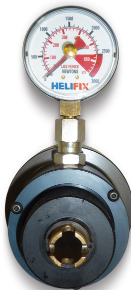
Obrázek 3.16: Testovací sada od firmy Helifix na zkoušení únosnosti výztuží zabudovaných ve vrtu. Převzato z [40].
