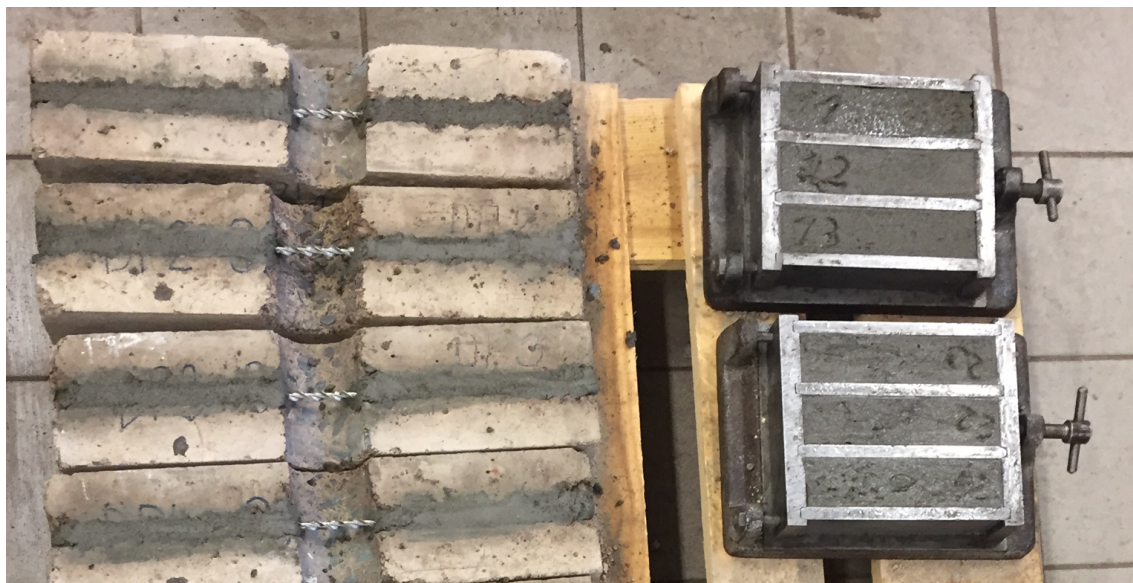
Obrázek 5.17: Vyrobená zesílená tělesa, včetně trámců na zkoušení kotevní zálivky.
