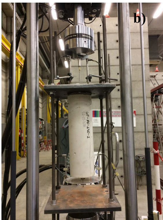
Obrázek 3.23: Ukázka zkušební sestavy pro zkoušení kotvení ve válci z kotevní zálivky. Na obrázku jde vidět použití plechového talíře pro měření pomocí snímačů. Převzato z [44].
