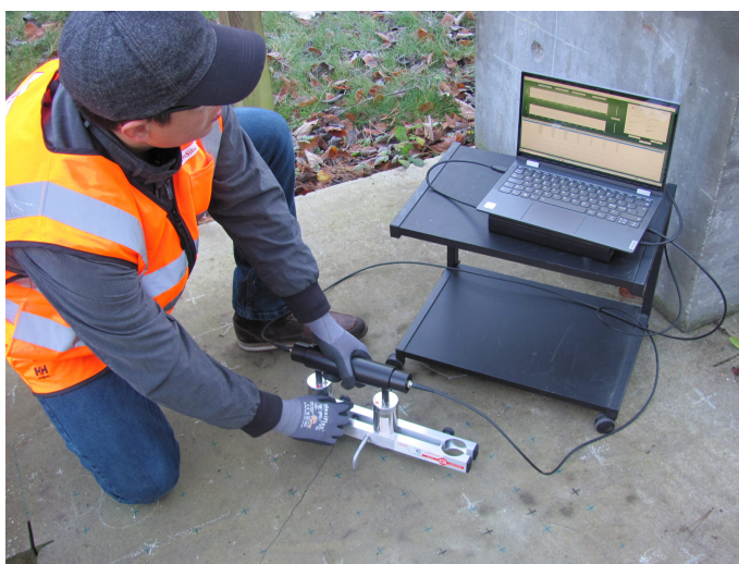
Obrázek 3.5: Metoda Impact-Echo – ukázka měření v terénu. Převzato z [18].
