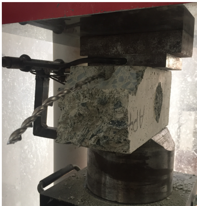
Obrázek 5.10: Sestava zkoušení pevnosti v tlaku – na obrázku lze vidět polovinu zkoušeného trávce, kdy přes nástavec je působeno silou na plochu 100 × 100 mm.
