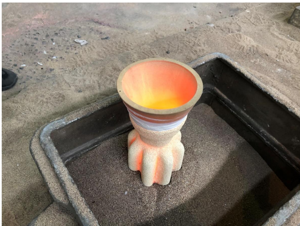
Obr. 21 Skořepinová forma krátce po vytažení z pece
