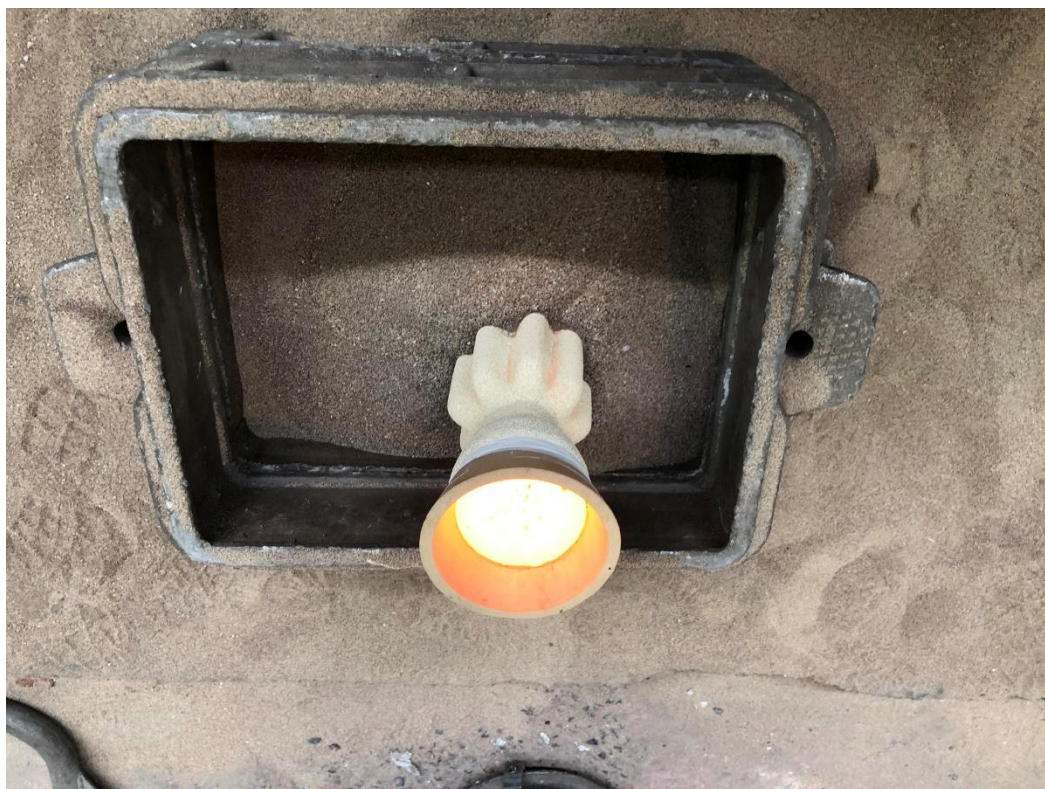
Obr. 23 Skořepinová forma krátce po odlévání
