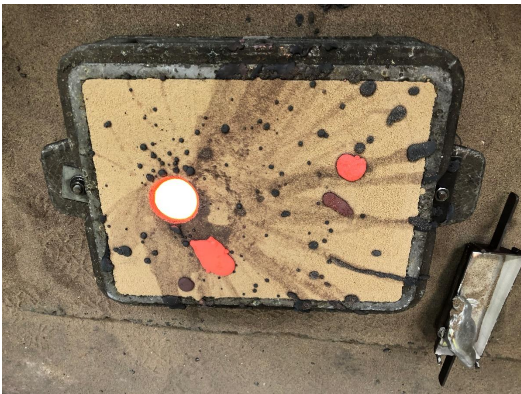
Obr. 16 Písková forma krátce po odlévání
