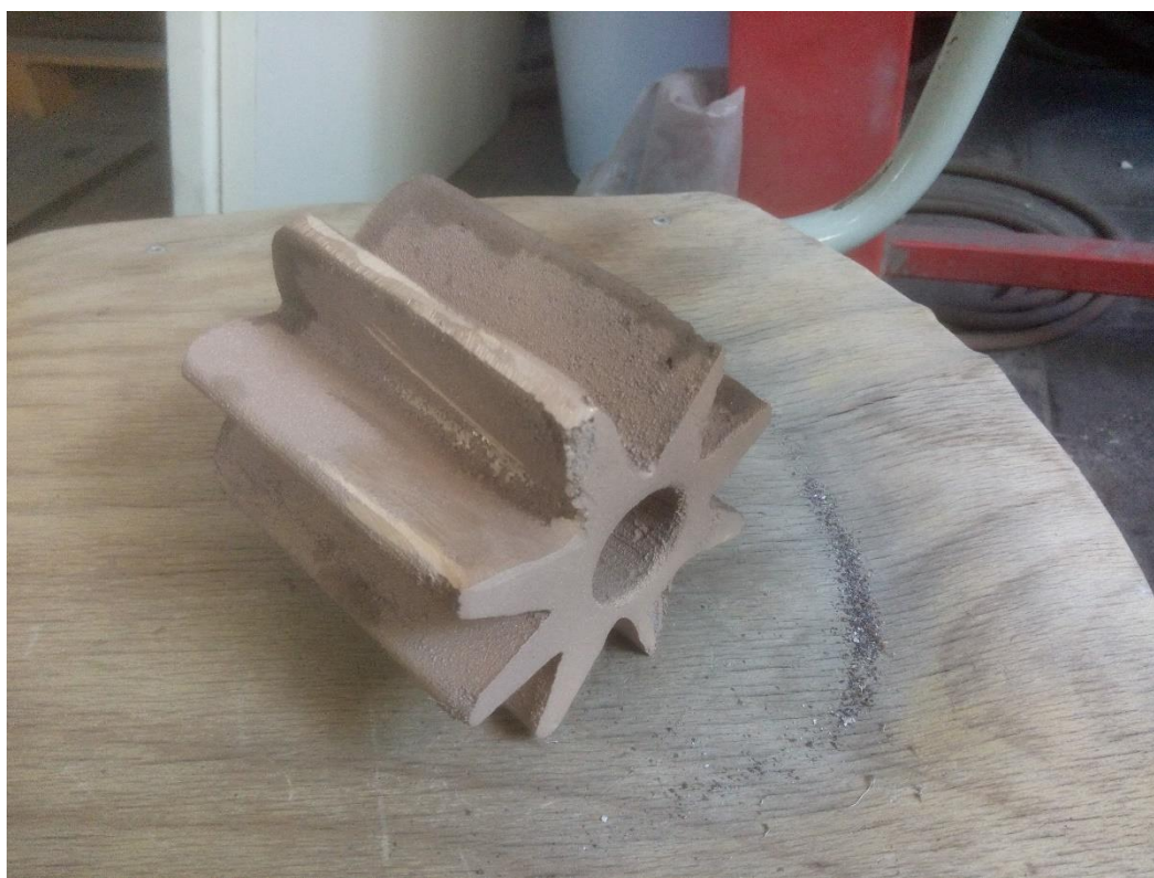
Obr. 25 Finální hlavice palcátu odlitá do pískové formy
