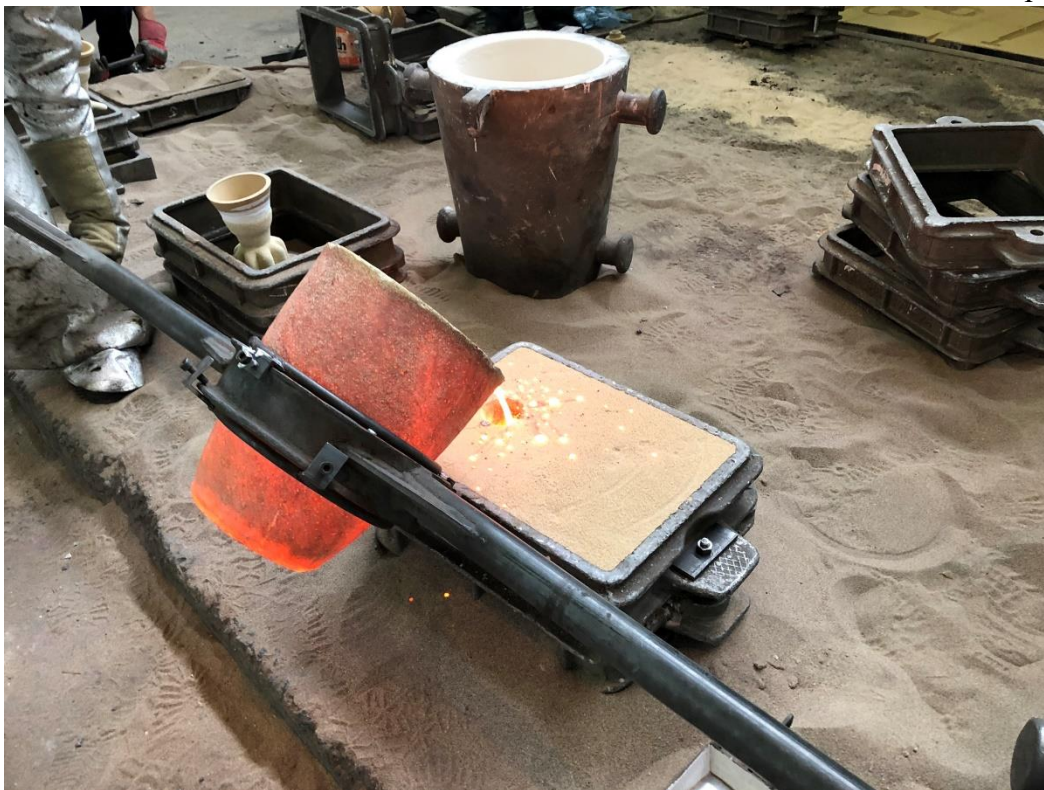
Obr. 15 Lití bronzu do pískové formy
