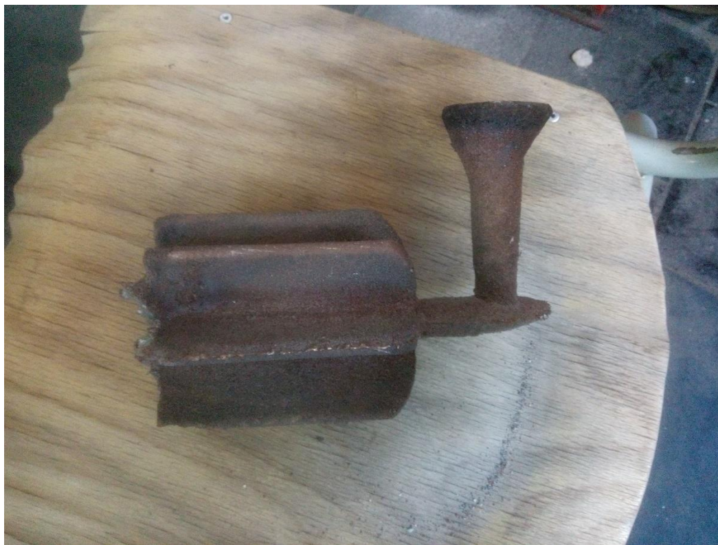
Obr. 17 Hlavice palcátu odlitá do pískové formy
