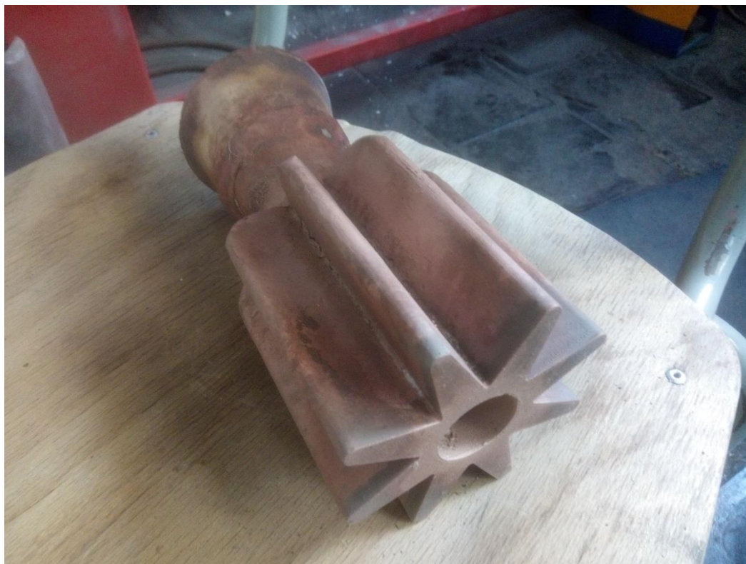
Obr. 24 Hlavice palcátu odlitá do skořepinové formy
