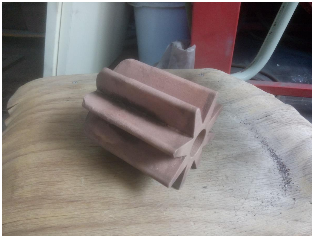
Obr. 26 Finální hlavice palcátu odlitá do skořepinové formy
