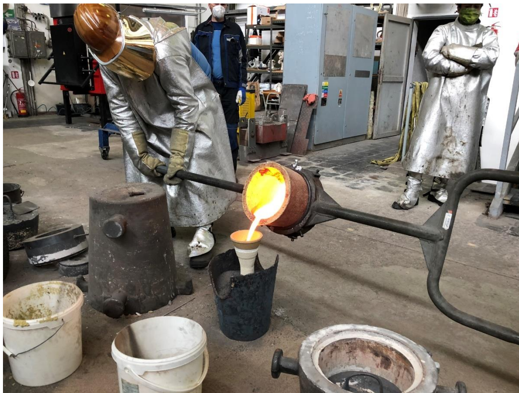
Obr. 22 Lití bronzu do skořepinové formy
