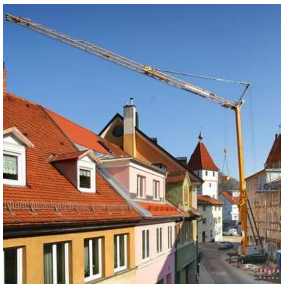
Obrázok 62 Vežový rýchlostaviteľný žeriav Liebherr 22 HM [26]
