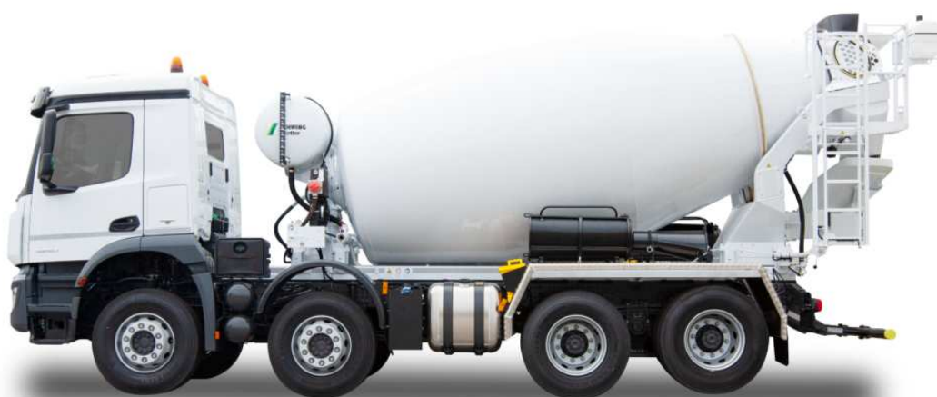
Obrázok 39 Auto domiešavač Schwing Stetter AM 10 BL [9]
