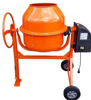
Obrázok 50 Stavebná miešačka Ma-tech 125 l FB max [19]
