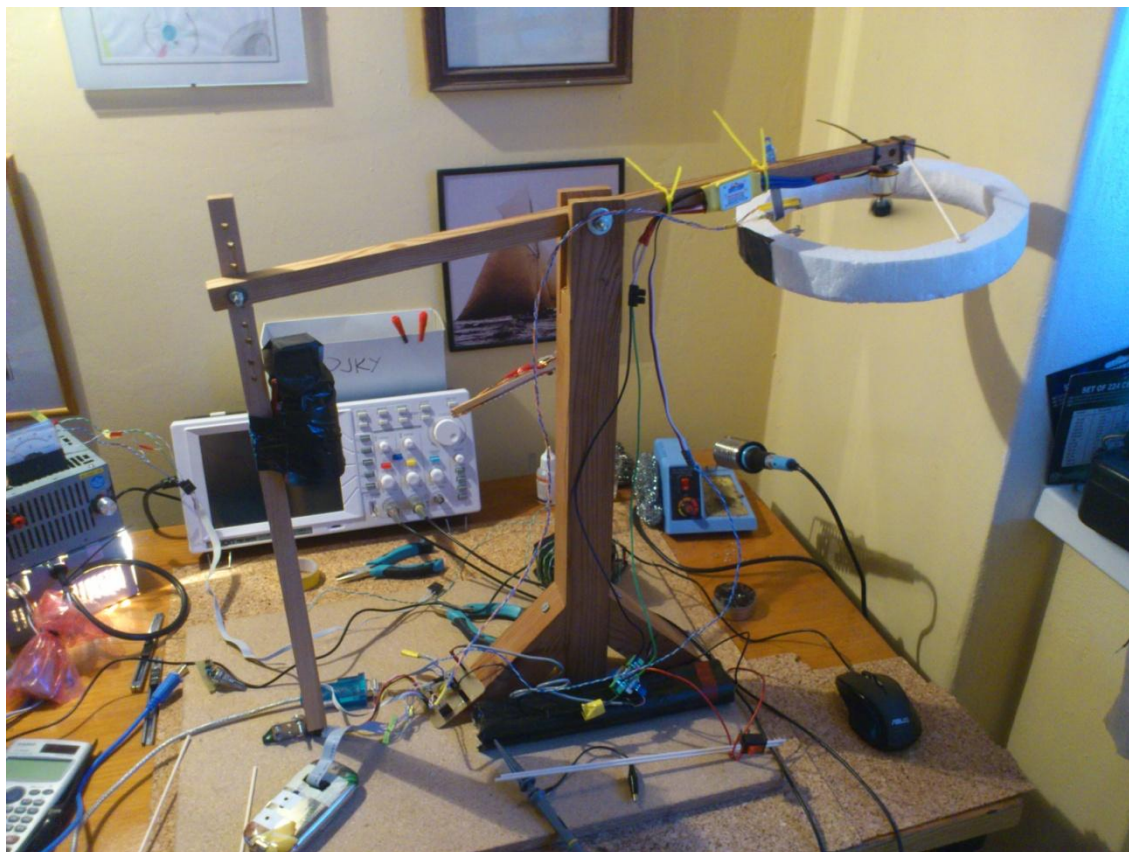
Obrázek 21: Fotografie přípravku. Zde při měření s prstencem upravujícím aerodynamiku.
