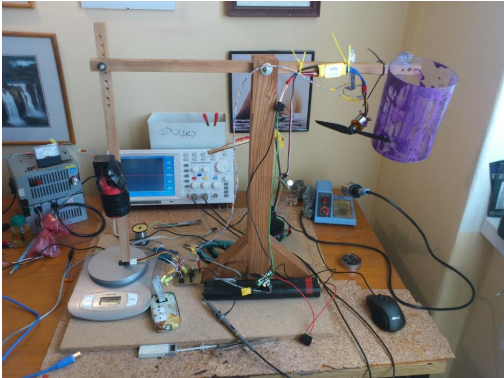
Obrázek 23: Úprava měřidla při kalibraci senzoru síly
