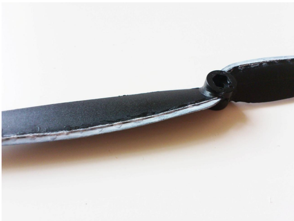
Obrázek 35: Vrtule č.1 modifikovaná jednoduchým turbulátorem
