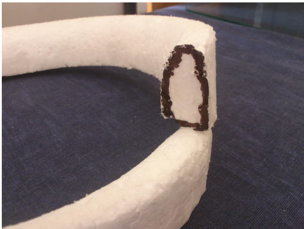
Obrázek 28: Prstenec číslo 1. Jedná se o jednoduchý válcový tvar se zaoblením na vnitřní náběžné hraně
