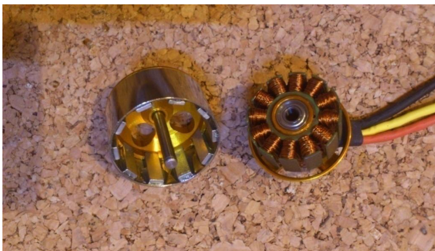
Obrázek 1: Konstrukce motoru: vlevo rotor s magnety, vpravo stator s vinutím.
