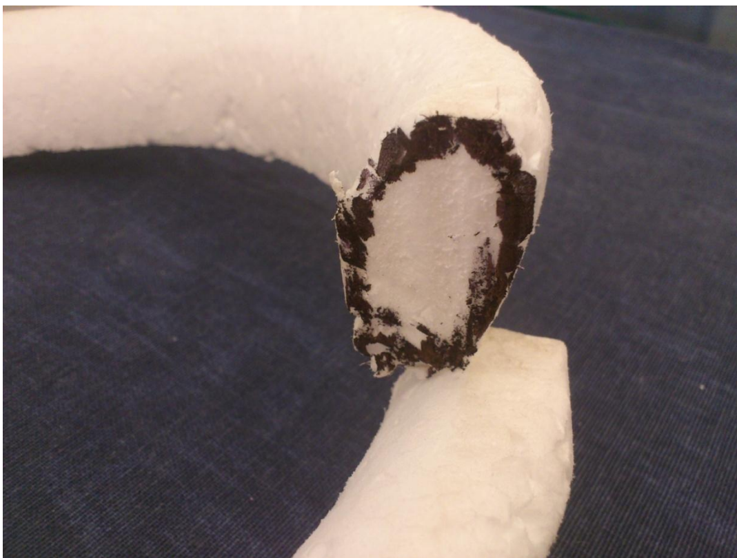
Obrázek 31: Prsteneček číslo 2, tvar průřezu prstenečku se blíží spíše tvaru profilu křídla
