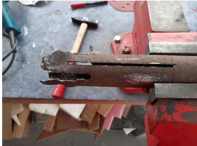
Obr. 8.3: Otvory pro průchod trnů (v levé části) a drážky pro vodící lištu
