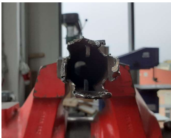
Obr. 8.4: Vnitřek kotvy s vodícími lištami
