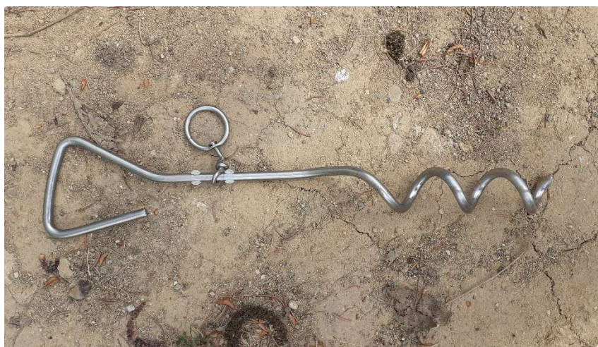
Obrázek 9.5: Deformovaná kotva č. 1
