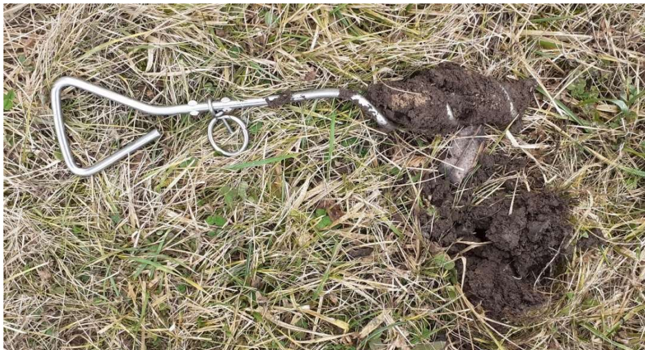
Obr. 7.1: Kotva č. 1 po vytažení ze země
