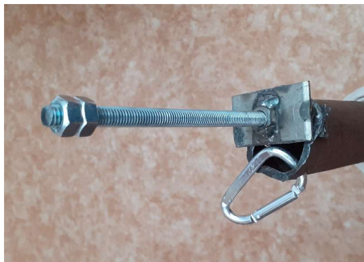
Obrázek 8.1: Horní část kotvy; patrná závitová tyč, vodící matice s podložkou a karabina pro uchycení
