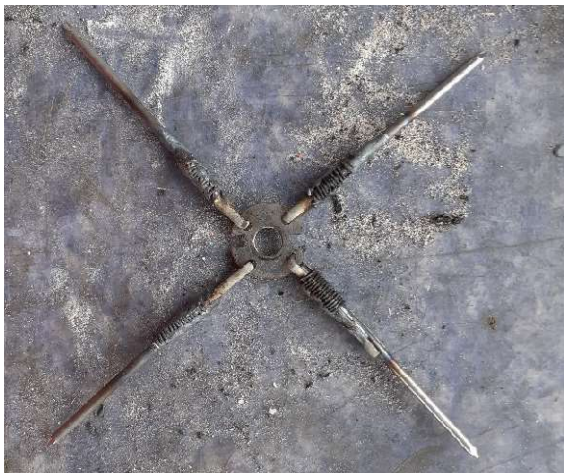
Obr. 8.2: Trny spojené s vodící podložkou
