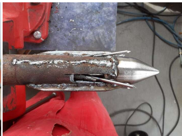
Obrázek 8.5: Hrot kompletní kotvy; patrné trny, otvory pro trny, vysoustružený hrot a výztuhy
