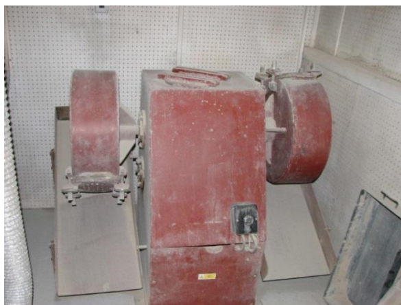
Obr. č. 42 Laboratorní kulový mlýn použitý pro mletí teplárenské strusky
