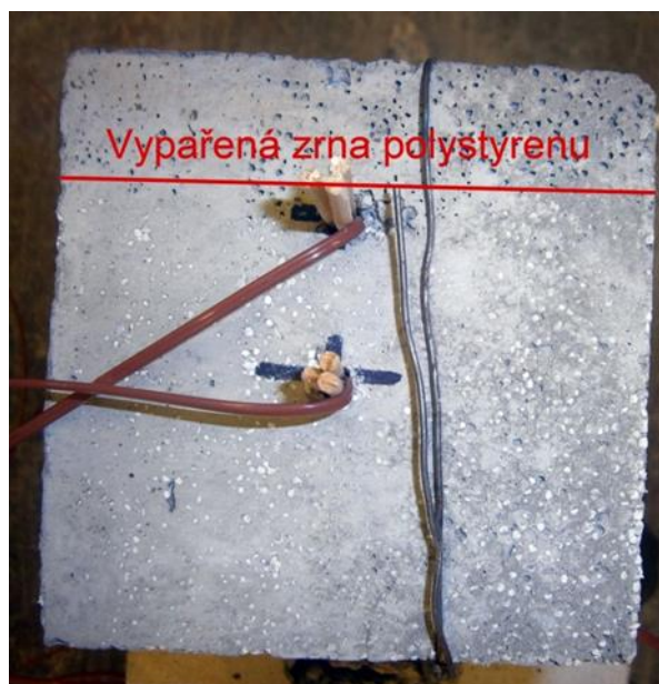
Obr. č. 52 Vypařená zrna polystyrenu ze zatěžovaného vzorku po zkoušce
