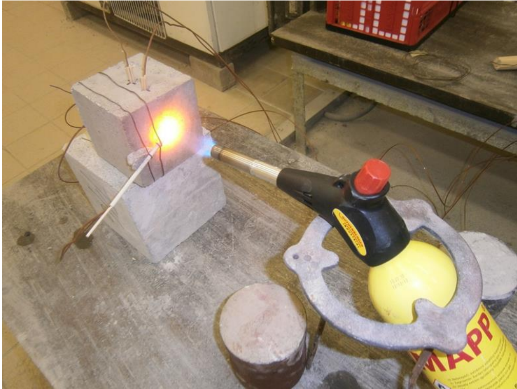
Obr. č. 49 Provádění zkoušky zatěžování plamenem
