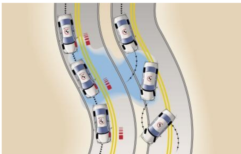
Obr. 3.4 Jízdní manévry vozidla s funkčním systémem ESP (vlevo), s nefunkčním systémem ESP (vpravo) [93]
