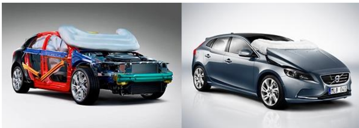
Obr. 1.3 Airbag pro chodce ve voze Volvo V40 [49]
