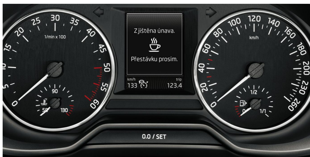
Obr. 4.6 Upozornění na únavu řidiče zobrazené na displeji ve vozidle Škoda Octavia [94]
