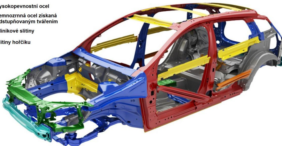
Obr. 1.1 Materiály použité na karoserii osobního automobilu Volvo V60 [119]
