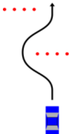
Obr. 3.3 Schéma dvojitého vyhybacího manévru [128]
