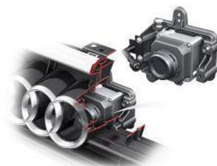
Obr. 4.4 Umístění termovizní kamery ve vozech značky Audi [79]
