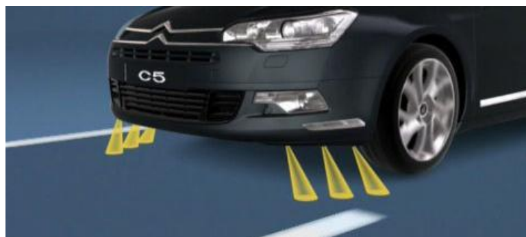
Obr. 3.8 Ultračervené snímače systému AFIL ve vozidle Citroën C5 [120]
