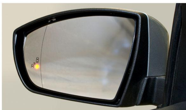
Obr. 3.10 Vnější zpětné zrcátko se zakřiveným zrcadlem (část vlevo od svislé čáry) a plochým zrcadlem (vpravo od svislé čáry) navíc doplněné o signalizační diodu systému pro zmenšení mrtvého úhlu [110]
