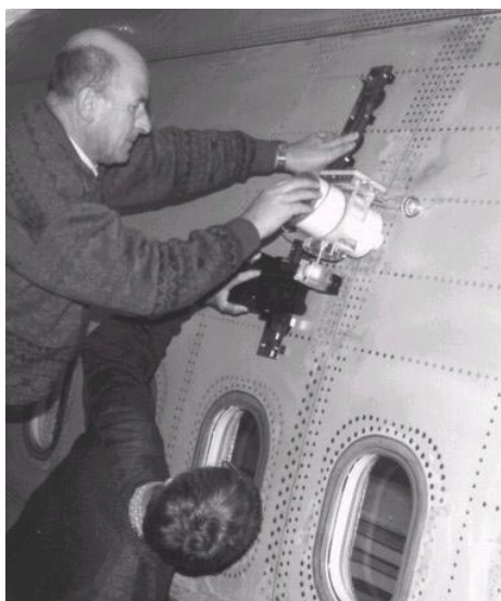
Obr. 9.5 Skenování trupu metodou vířivých proudů 34
