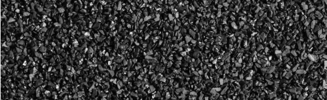
Obrázek 21: Granulované (zrnité) aktivní uhlí, převzato: [63]
