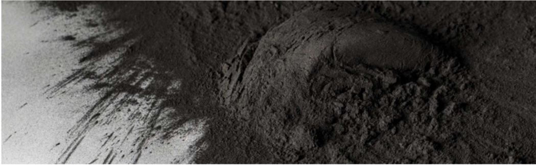
Obrázek 20: Práškové aktivní uhlí, převzato: [63]
