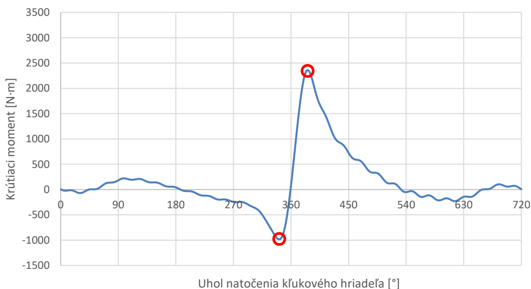
Obr. 34 Priebeh periodického momentu modifikovaného motora (1500 min -1 )
