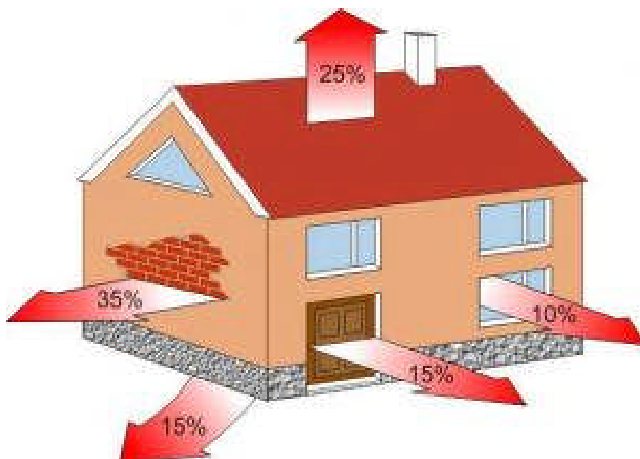
Obrázek č. 1.2 – Průtok tepelných ztrát budovy
