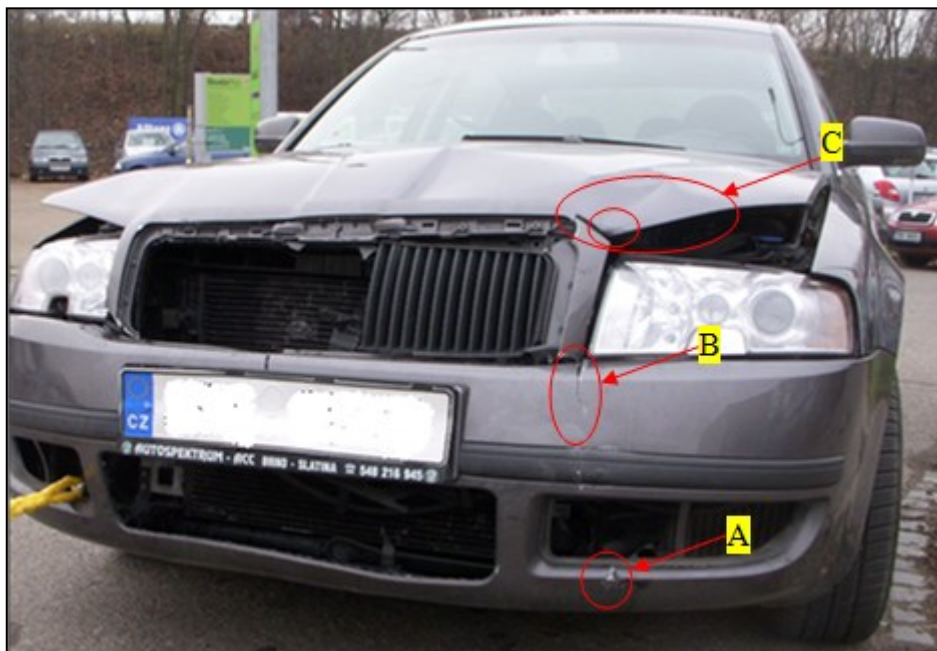
Obrázek č. 8 – Poškození z předešlé dopravní nehody [5]
