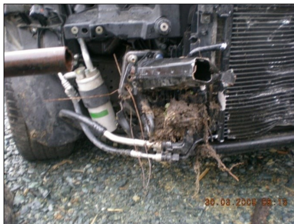
Obrázek č. 5 – Poškozená pravá přední část vozidla Škoda při ohledání a hlína nalezená při prohlídce [5]
