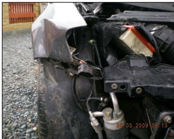
Obrázek č. 5 – Poškozená pravá přední část vozidla Škoda při ohledání a hlína nalezená při prohlídce [5]
