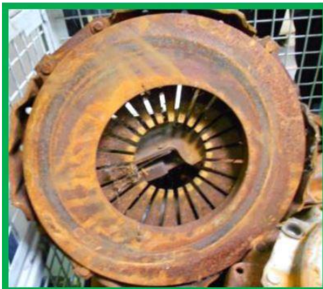
Obr. 2.21 Zkorodovaný přítlačný talíř [23]
