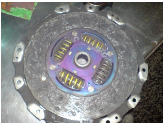
Obr. 2.18 Spečené třecí obložení Nissan PickUp
