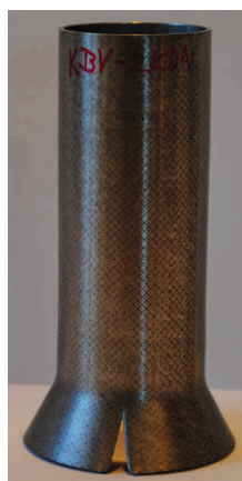
Obr. 57: Výsledný vzorek s vrubem
