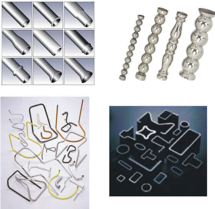
Obr. 1: Příklady tvářením trubek [4], [24], [25], [26],
