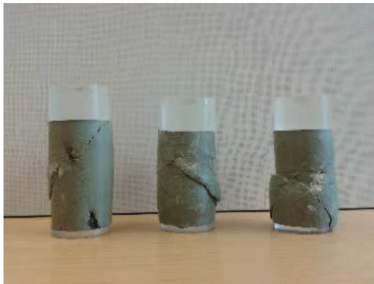
Obr. 4-6: Porušené vzorky z triaxiální zkoušky
