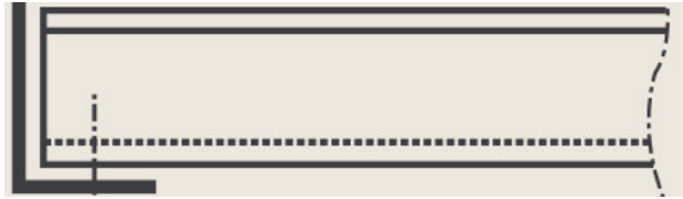
Obr. 51 Bednění okraje desky
