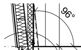
Obr. 47 – Odklon šikmé fasády
