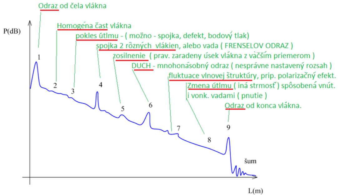
Obr. 5.5: Prejav bodových porúch pri meraní pomocou OTDR, zdroj :[1]
