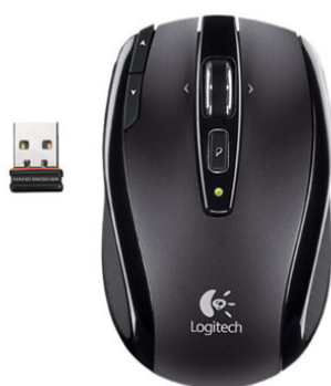
obr. 4.4 bezdrátová myš k notebooku a mikro přijímač do USB
