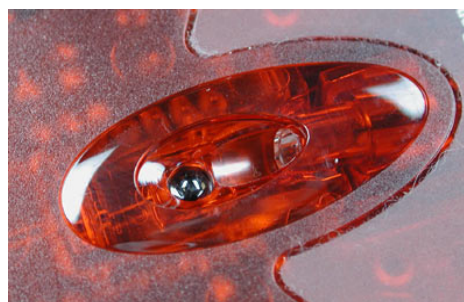
obr. 3.3 detailní pohled na diodu a fotorezistor
