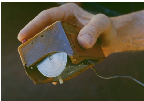
obr. 2.3 pohled na dva ovládací kotoučky ( „X-Y Position Indicator.“ 1970)
