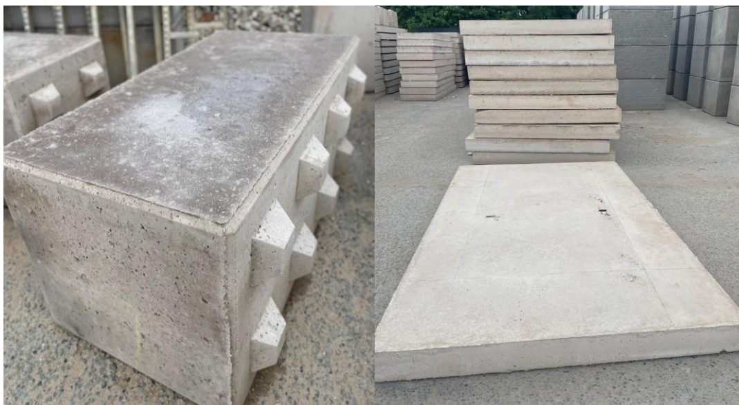
Obr. 81: Vyrobené systémové legobloky a silniční panely
