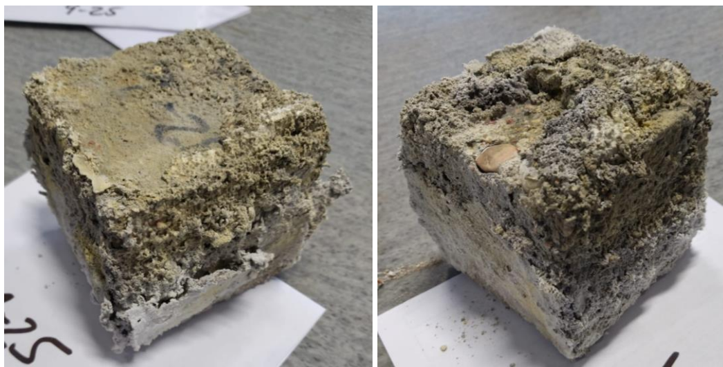
Obr. 82: Těleso po expozici 360 dní v prostředí aerosolu SO 2
