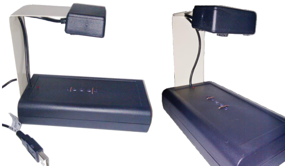
Obr. 13 - Realizované zařízení pro snímání větvení žil prstu
