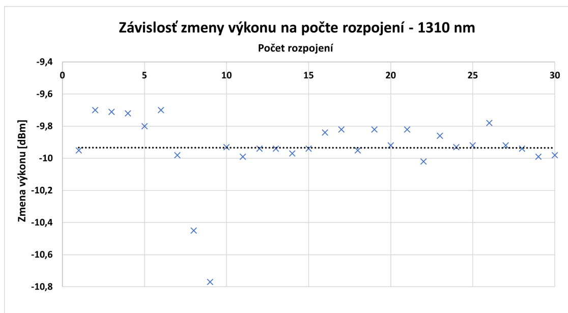
Obr. 4.6: Graf závislosti zmeny výkonu na počte rozpojení konektora E2000 pri vlnovej dĺžke 1310 nm
