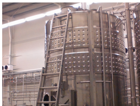
Obrázek 4.2: Nerezový tank firmy Wottle s chladicím pláštěm [32].
