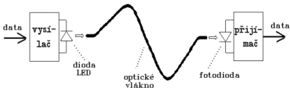
Obrázek č. 8: Optický přenosový systém
