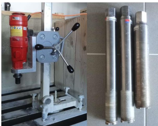
Obrázek 3-3: Vrtačka WEKA DK 17 a použité jádrové vrtáky, foto: autor
