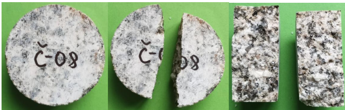
Obrázek 3-18: Ukázka porušení tělesa Č-08 příčným tahem, foto: autor
