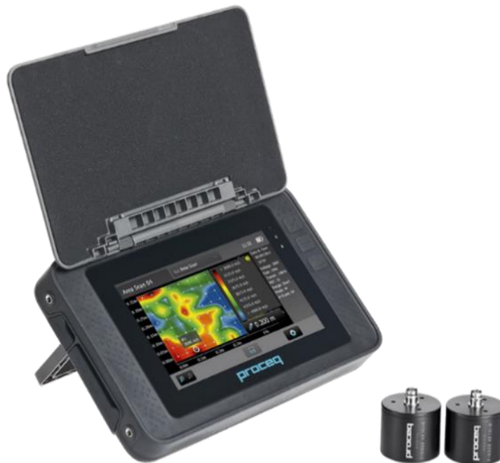
Obrázek 2-9: Ukázka přístroje Pundit 200 (Proceq) pro ultrazvukovou impulzovou metodu využitého v bakalářské práci, převzato z [29]
