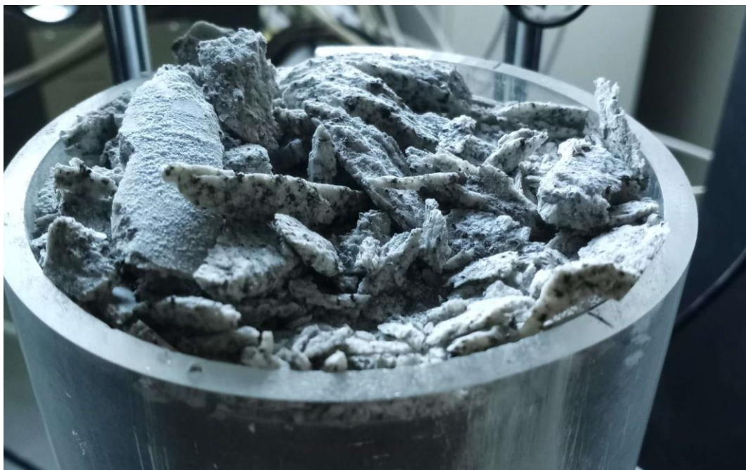
Obrázek 3-17: Menší úlomky tělesa R-01, které při porušení explodovalo, foto: autor
