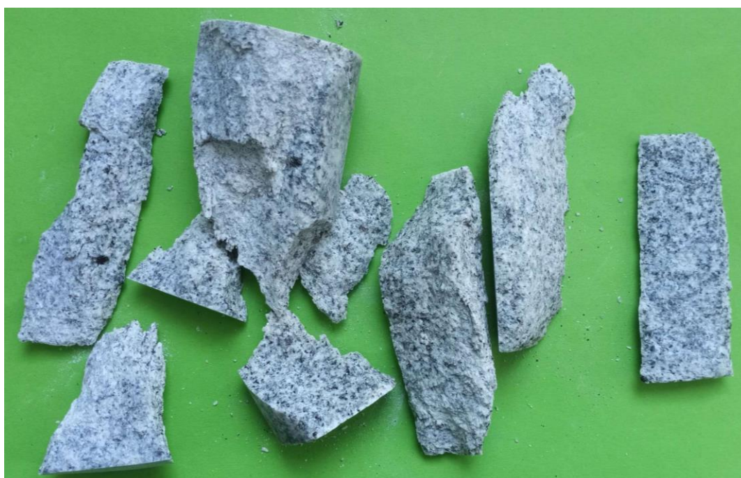
Obrázek 3-16: Větší úlomky tělesa R-01 po křehkém porušení, foto: autor
