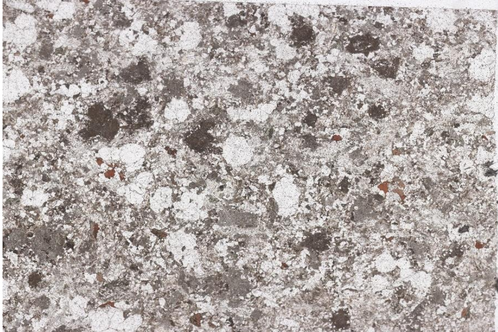
Obrázek 3-8: Ukázka hrubozrnného granitu typu Čeřínek s variabilně přeměněnými alkalickými živci, které částečně vystupují ve formě tzv. pseudomorfóz, Čertův hrádek (délka snímku: 4 cm), foto: Lukáš Krmíček
