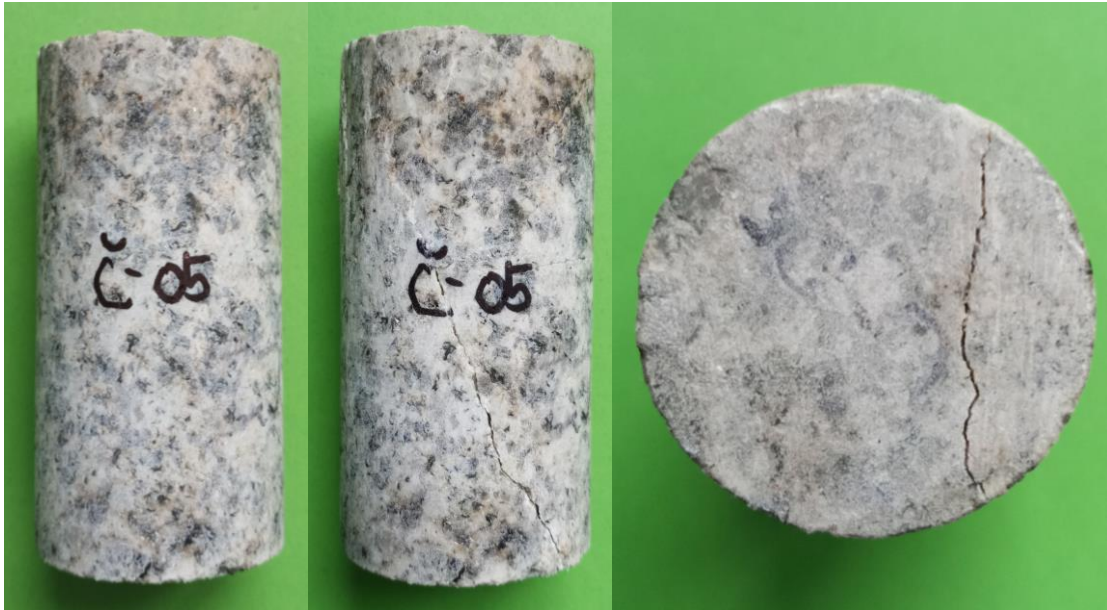
Obrázek 3-20: Porušení tělesa Č-05 při triaxiální zkoušce šikmou trhlinou, foto: autor
