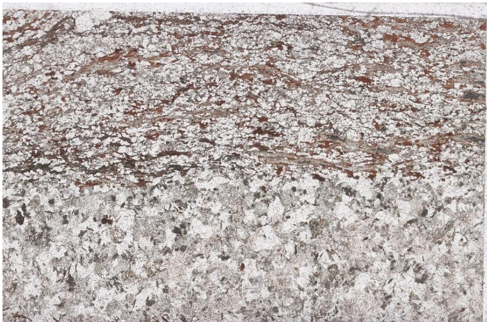
Obrázek 3-7: Ukázka kontaktu biotitické ruly s granitem typu Mrákoťín, lom Rácov. Alkalické živce granitu jsou zakaleny produkty sericitizace (délka snímku: 4 cm), foto: Lukáš Krmíček
