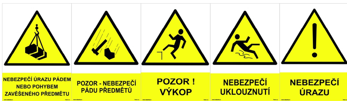
Obr. 5.4 – Výstražné značky na staveništi (zdroj: www.asig.cz)
