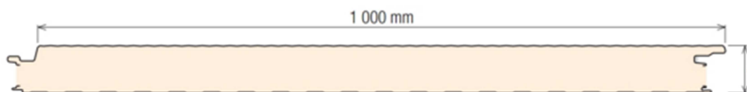
Obr. 9.2 – Řez fasádního panelu – KS1000 WL (zdroj:www.kingspan.cz)
