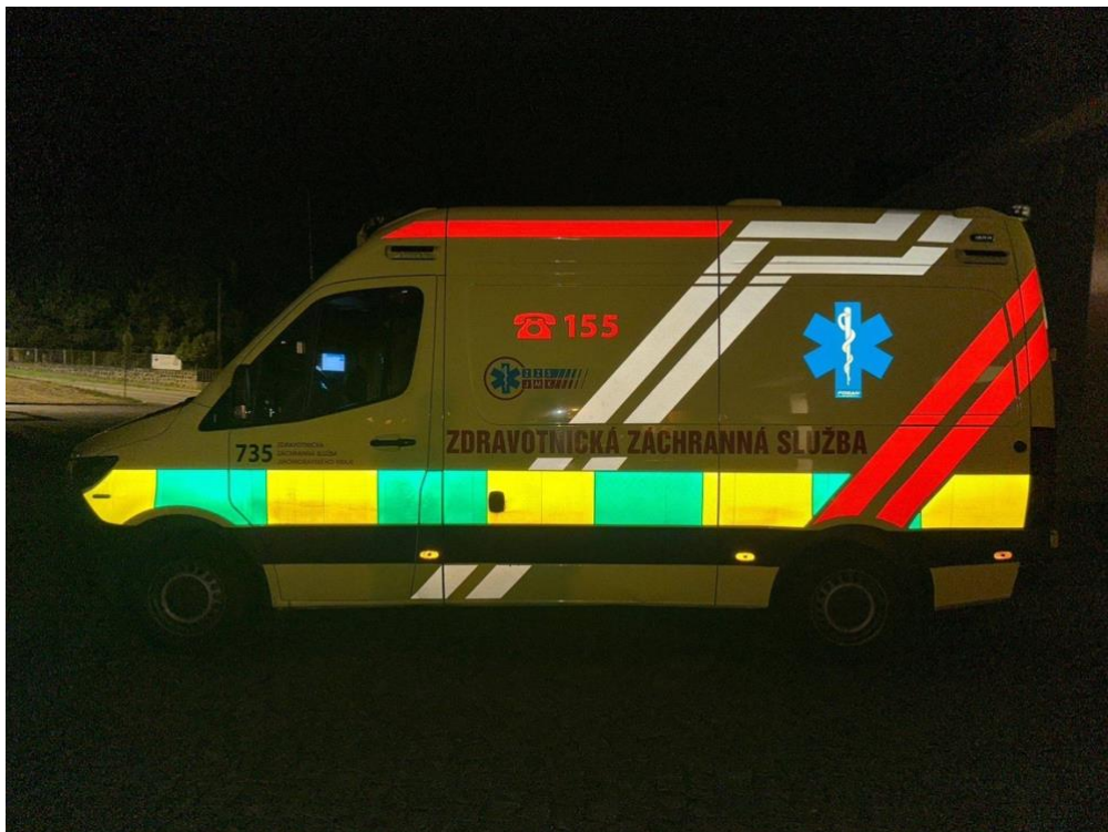
Obrázek 34: Retroreflexní označení sanitního vozidla [vlastní]
