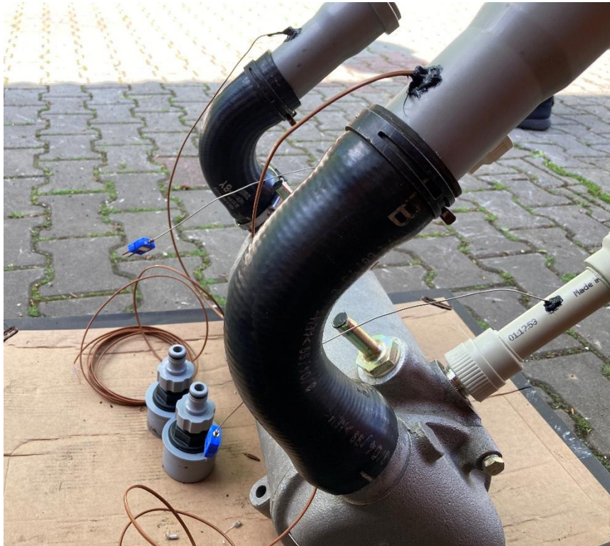
Obr. 58 Nainstalované termočlánky a utěsněné silikonem
