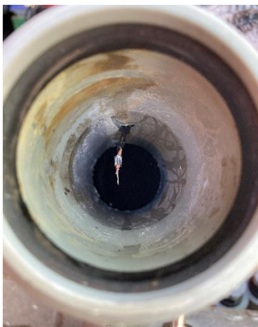
Obr. 61 Pozice konců termočlánků v potrubí pro horkou a studenou vodu
