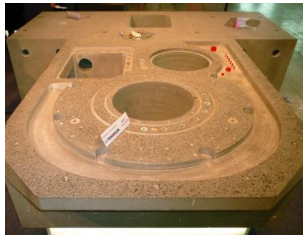
Obr.10. Betonové lože stroje powerturn [18]
