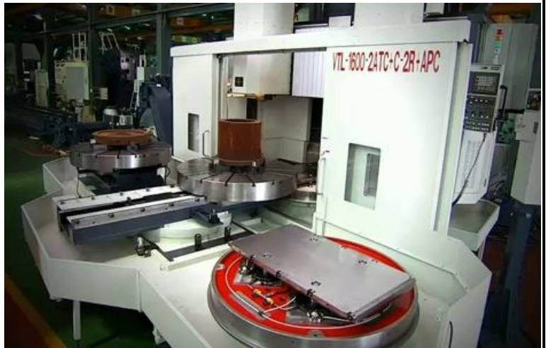
Obr.17. Automatická výměna obrobků [23]
