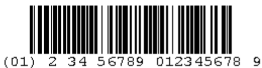
Obr. 21 Příklad čárového kódu "Code 128" (Zdroj: Vlastní zpracování)
