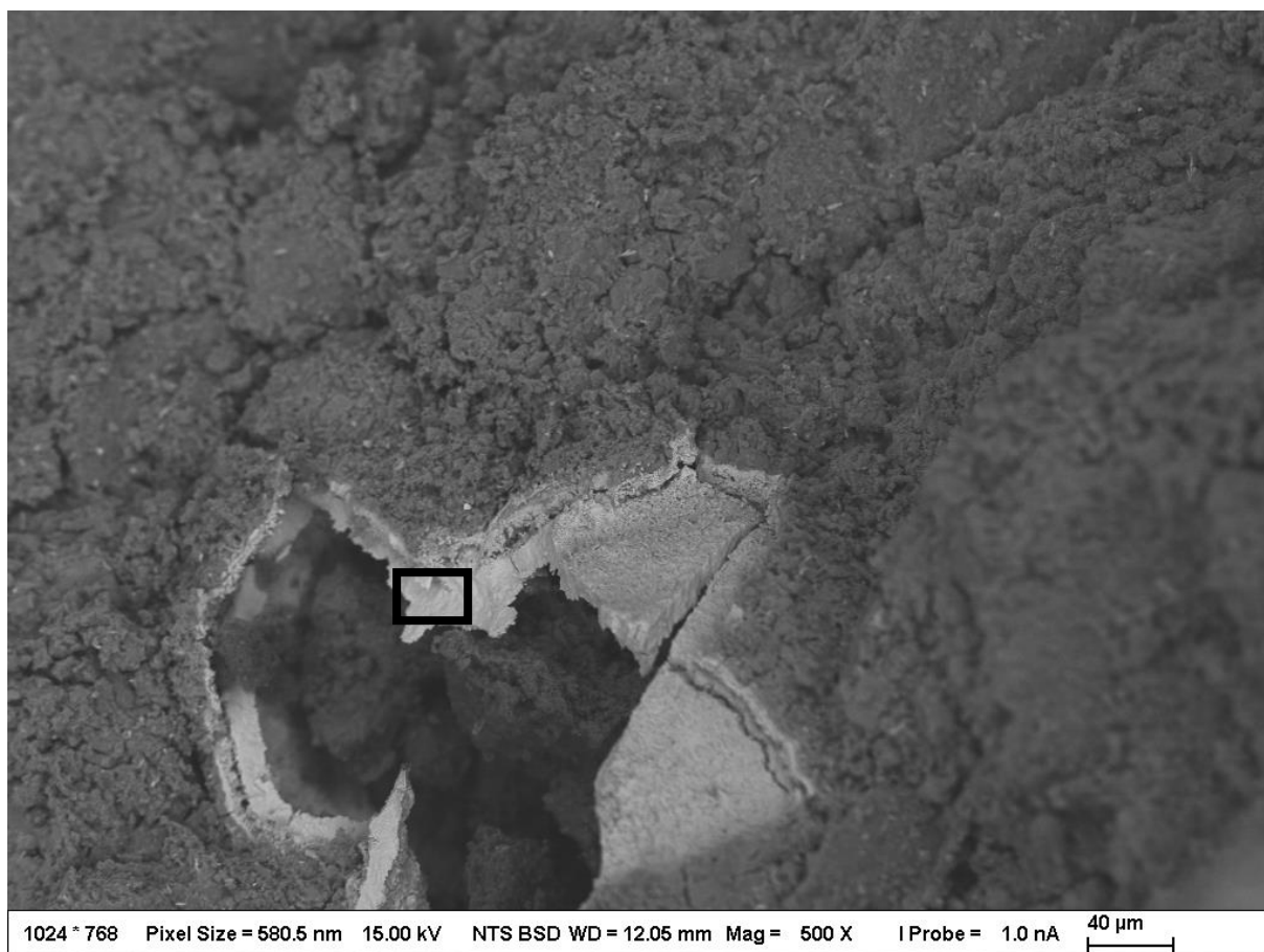
Obr. 21: Snímek ETI s viditelně kumulovaným olovem na SEM pomocí zpětně odražených elektronů s vyznačenou oblastí měřenou pomocí EDS
