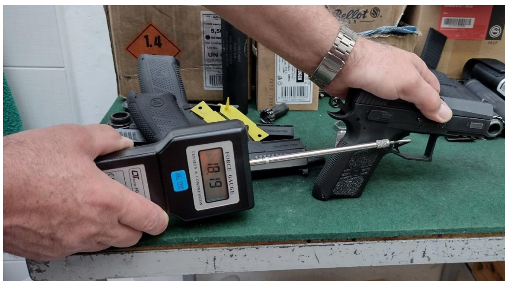
Obrázek 3.2.2 Měření odporu spouště siloměrem na pistoli CZ P-07 v režimu SA
