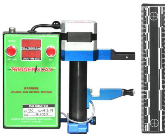
Obrázek 2.4.1 Měřicí systém TriggerScan [TGS21]
