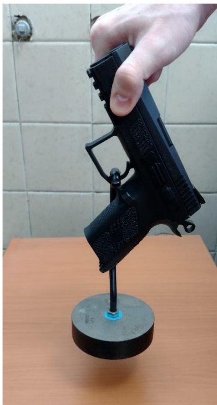
Obrázek 3.2.1 Měření odporu spouště závažím na pistoli CZ P-07 v režimu SA
