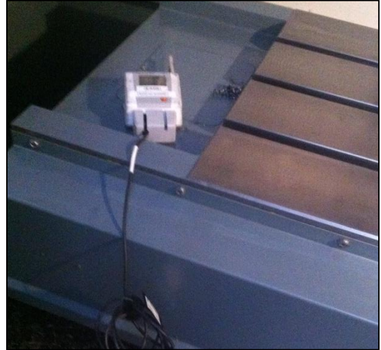
Obr. 3.4: Umístění teplotního snímače Testo Saveris pro osu X
