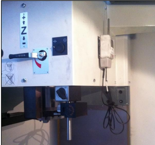
Obr. 3.3: Umístění teplotního snímače Testo Saveris pro osu Z
