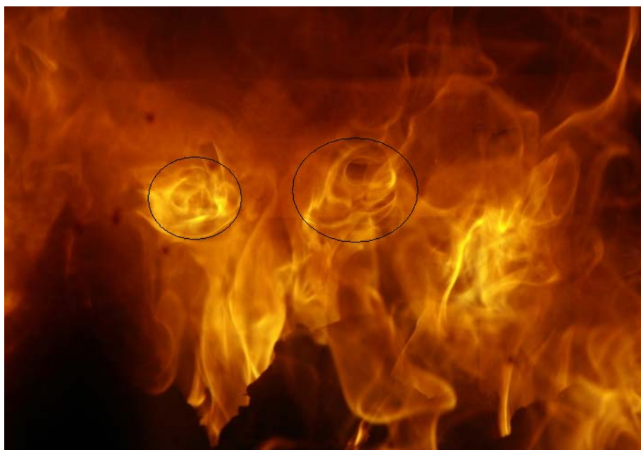
Obr. 16 Vliv sekundárního vzduchu na průběh hoření
