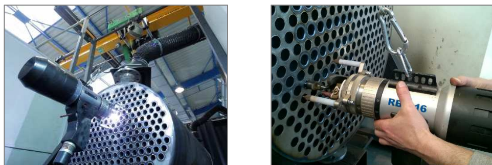
Obr. 23 Pomocná konstrukce – balancér a nastavení orbitální hlavy [1].
