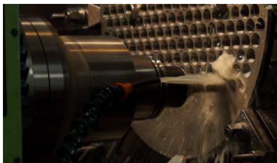
Obr. 13 Pracoviště operátora a vrtání jednotlivých otvorů trubkovnice.
