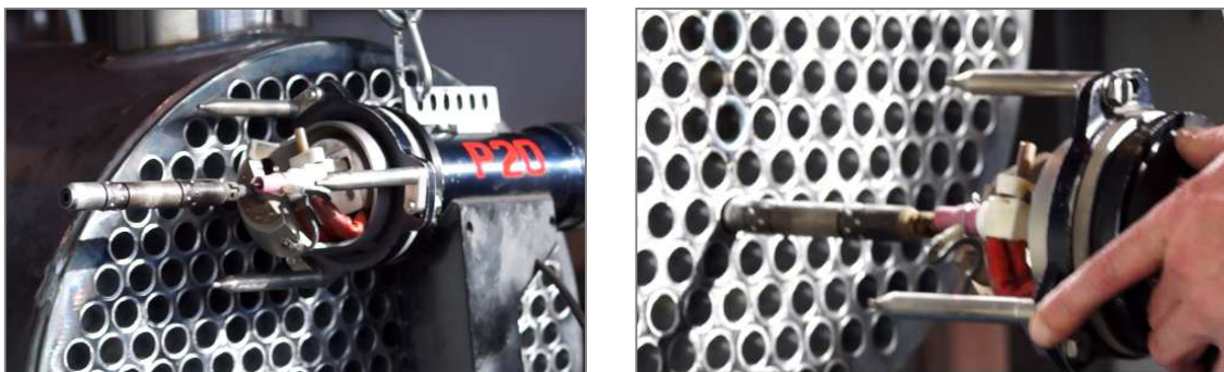
Obr. 25 Odpružený hrot orbitální hlavy a nastavení před procesem svařování [1].
