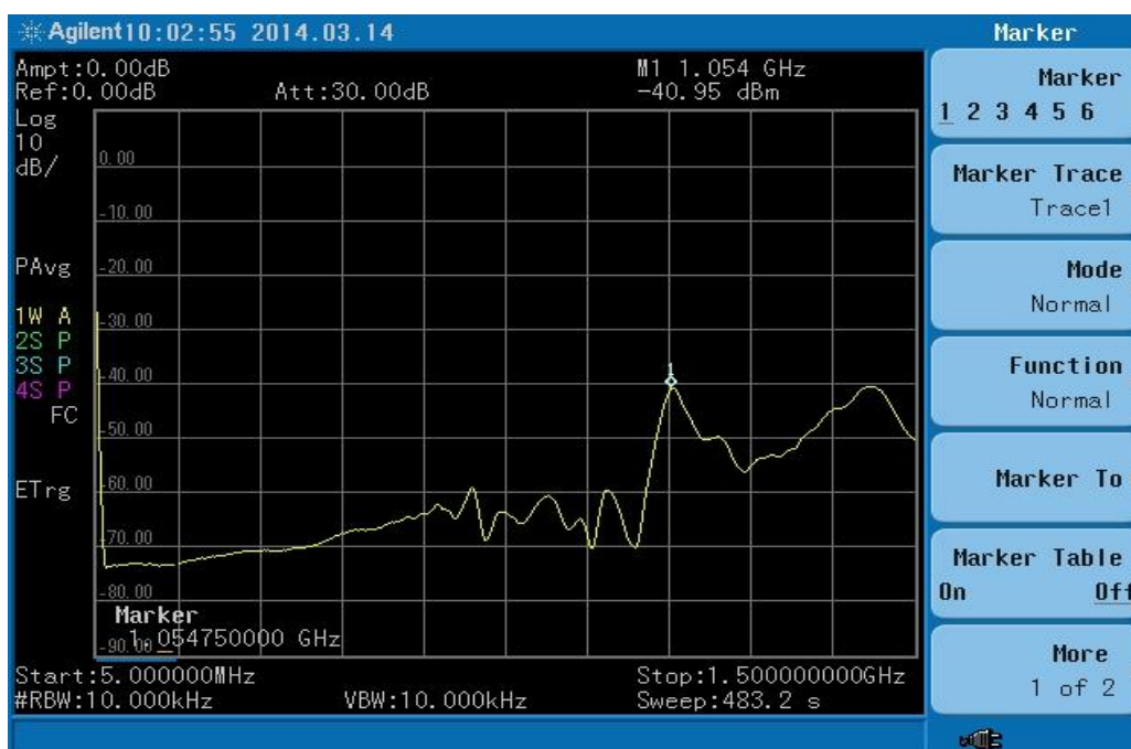
Obr. 5.7: Reálný přenos vstupního filtru na 50 Ω do 1,5 GHz
