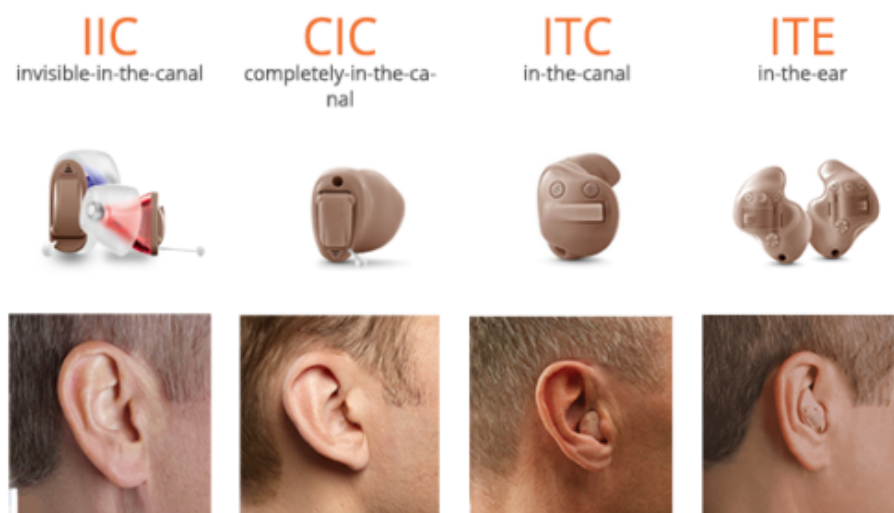
Obrázek 3.5 Typy zvukovodových sluchadel [32]
