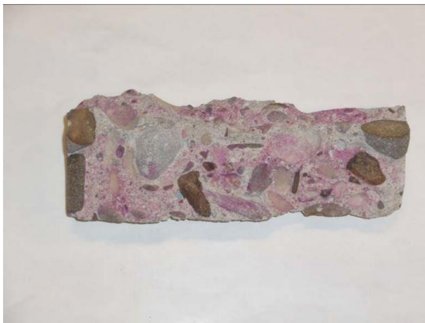
Obrázek 4 - Acidobazická reakce zdravého betonu při fenolftaleinové zkoušce
