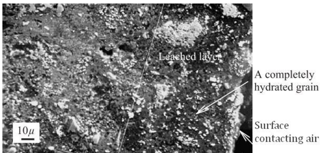
Obrázek 6 - Detail části mikrostruktury předchozího obrázku CSA - vysokopevnostního betonu, která byla ve styku se vzduchem. Stáří betonu - 5 let. Obrázek pořízen metodou BSE [8]
